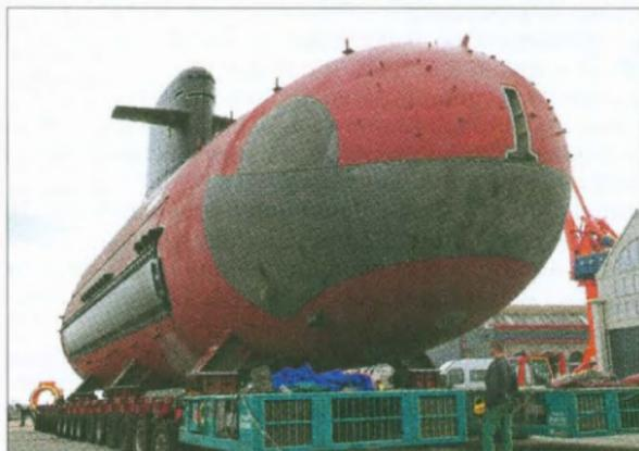
*На судовой верфи в г. Шербур строятся дизель-электрические подводные лодки типа «Скорпен»*
