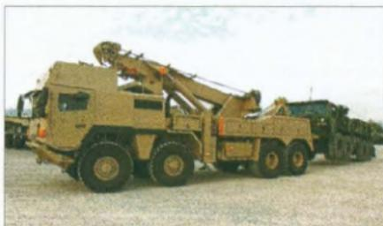
также двумя независимыми лебедками HZ 090 и TR 200 – главной эвакуационной лебедкой с 30-т тяговым усилием на крюке. Машина имеет также специальное оборудование. У сторон есть договоренность, что установка ремонтного модуля «Миллер» будет производиться на заводе «МАН тракс бас» на территории Дании.
