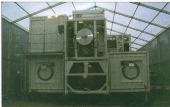
*Вид системы декомпрессии компании «Дайвекс» в разрезе (показана модульная конструкция на основе стандартных ISO-контейнеров. Слева виден приемно-шлюзовой отсек для стыковки с СГА, спереди – одна из декомпрессионных камер, главный отсек которой вмещает 30 спасенных, а также меньший отсек на шесть человек – для оказания медицинской помощи пострадавшим; справа показана лицевая часть модулей системы декомпрессии)*
